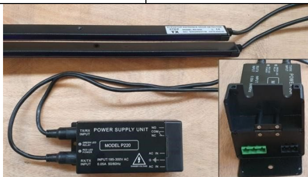
Рисунок 15.7 - Фотобарьер с блоком управления
