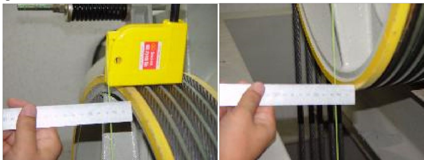
Рисунок 4.14 - Корректировка положения относительно осевого направления отводного и основного шкивов - измерить расстояние между основным и отводным шкивом.
