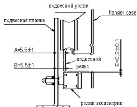
Рисунок 8.2 - Регулировка ролика эксцентрика
