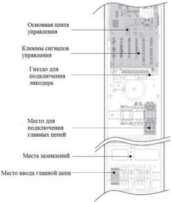
Рисунок 3-2 Схема расположения внутреннего и внешнего интерфейсов шкафа управления без машинного помещения
