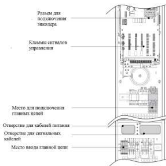
Рисунок 3-14 Схема подключения внешнего интерфейса шкафа управления без машинного помещения
