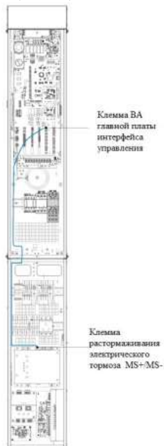
Рисунок 1-17 Принципиальная схема подключения электрического растормаживающего устройства для шкафа управления без машинного отделения
