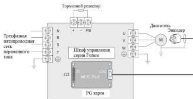
Рисунок 3-11 Принципиальная электрическая схема соединений между MCTC-PG-E и шкафом управления серии Future
