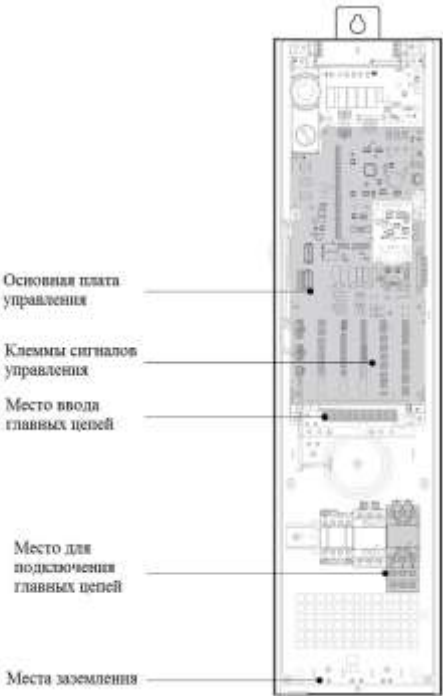
Рисунок 3-1 Схема расположения внутреннего и внешнего интерфейсов шкафа управления машинного отделения.
