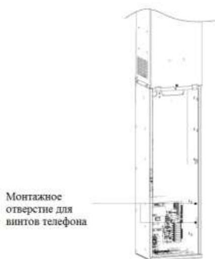
Рисунок 2-12 Принципиальная схема установки телефона для лифта без машинного помещения
