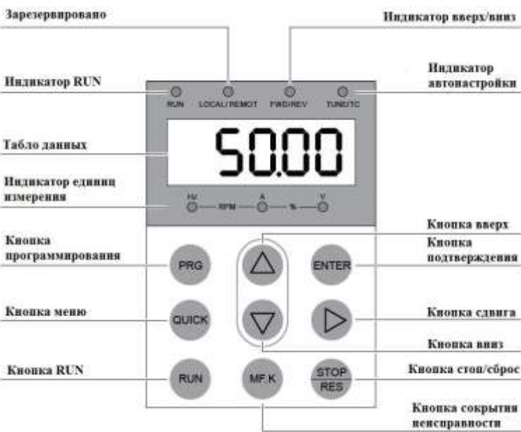
Рисунок 4-3 Принципиальная схема внешнего вида панели управления
