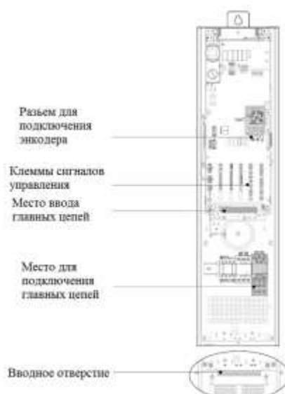
Рисунок 3-13 Схема подключения внешнего интерфейса шкафа управления машинного отделения
