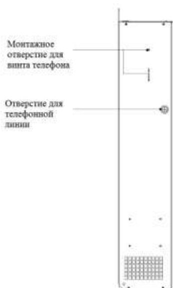
Рисунок 2-11 Принципиальная схема установки телефона в машинном помещении
